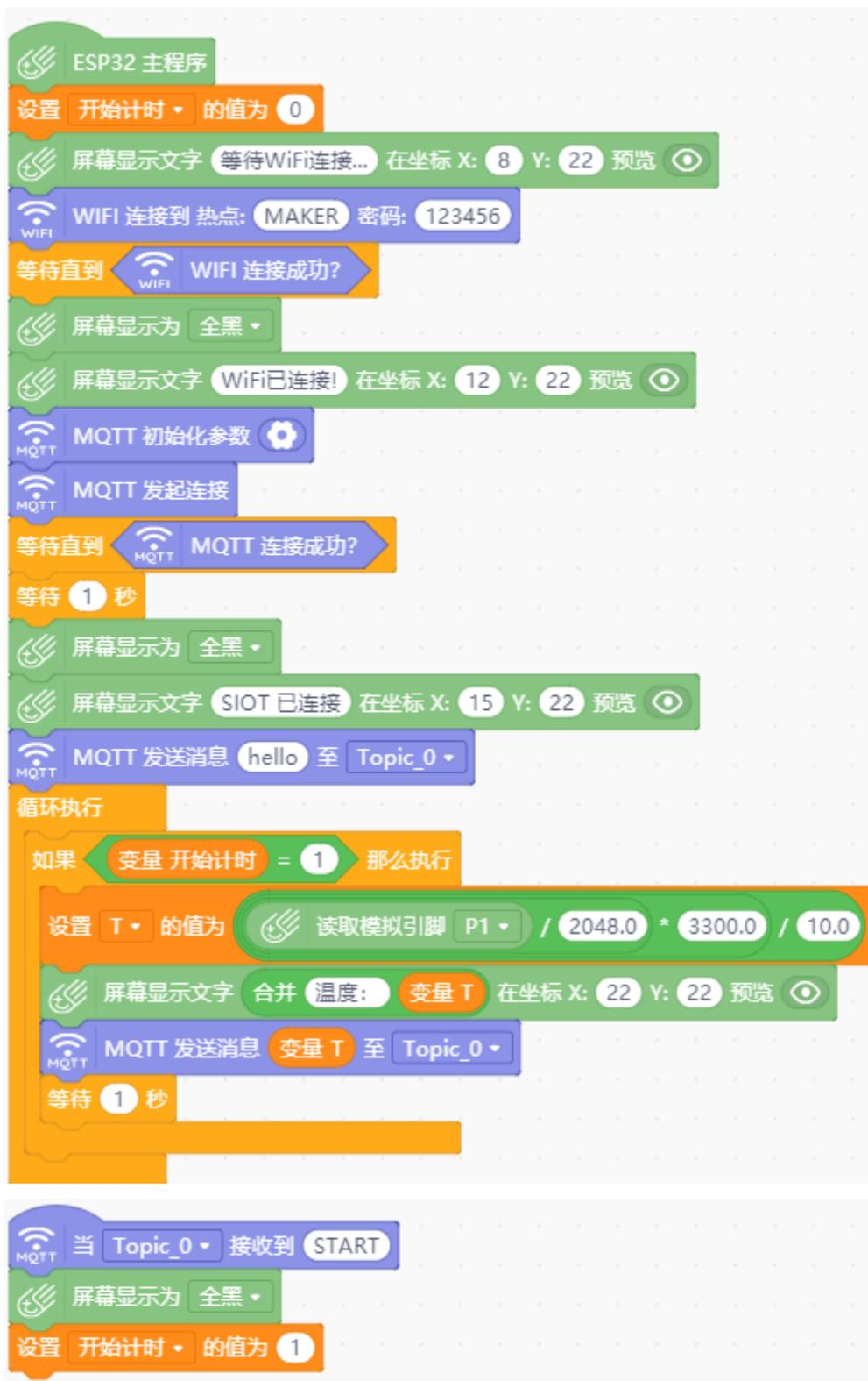
要确保掌控板连上 SIoT，务必正确配置 MQTT 的初始化参数，初始化信息解读如图：
