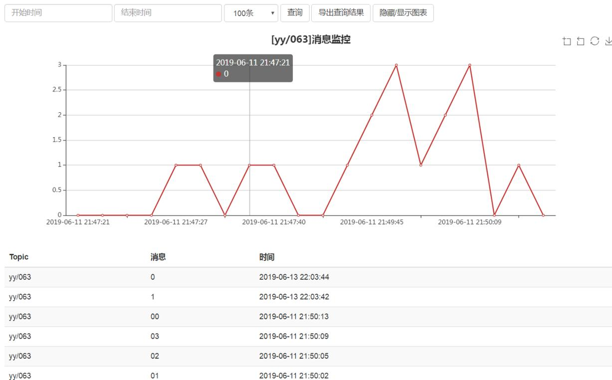
在名称为 “yy” 设备消息中，当发送 “01” 时，就可以控制掌控板的红灯亮；发送 “02” 时，就可以控制掌控板亮绿灯；发送 “03” 时，控制掌控板亮蓝灯；发送 “00”，控制掌控板灯熄灭。
