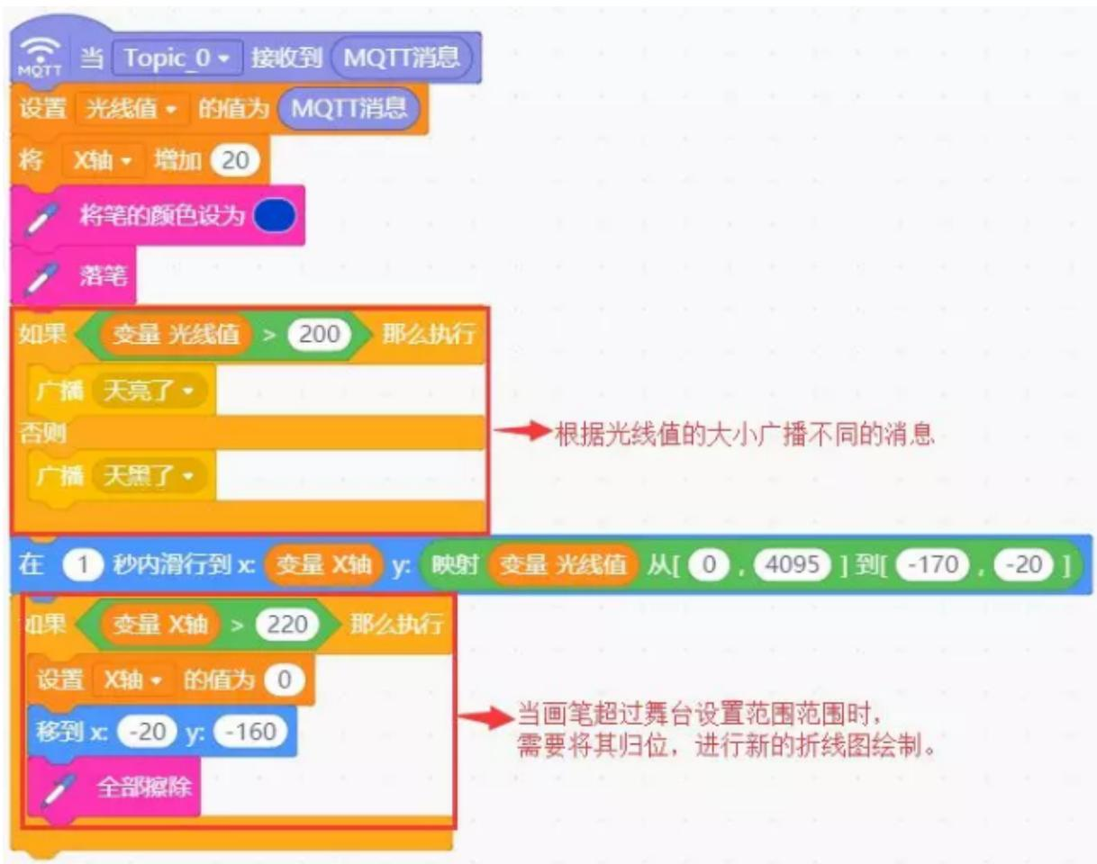
下面的程序需要在实时模式舞台中新建角色才能实现更换造型的效果（新建角色成功如下图），更换造型太阳和星星来区分昼夜。在此项目因为在常规环境中，光线传感器的返回值一般为 0，在本项目中设置的分界点为 200，在项目实施中可通过手机手电筒照射在传感器上感受数值的变化并观察在舞台中的效果。
